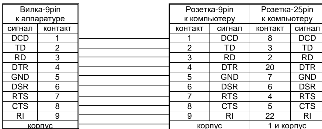
Рисунок 4.1.3 - Схема модемного кабеля типа «ООД – АКД». Сигналы готовности и квитирования не используются
