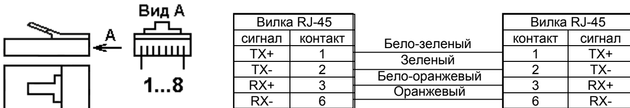
Рис.4.3.2.1 – Вид контактов разъема RJ45 и схема кабеля для соединения по интерфейсу Ethernet10/100
