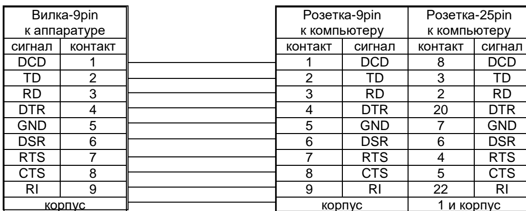
Рисунок 4.3 – Схема модемного кабеля типа «ООД – АКД». Сигналы готовности и квитирования не используются
