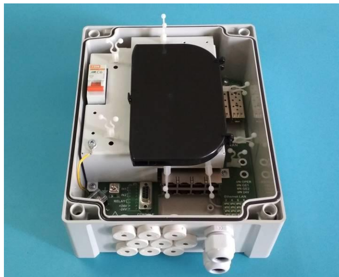
Рисунок 2.7 – Внешний вид: а) Корунд-2о-8Е8Р-0ВВ-ХМ; б) Корунд-2о-8Е8Р-0ВВ-ХХ
