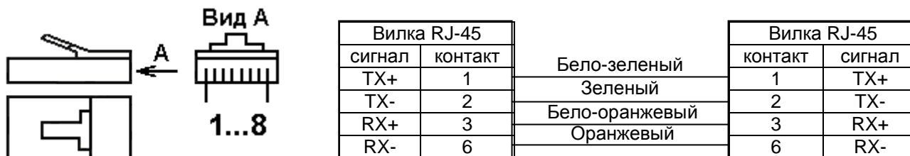
Рис.4.10 Вид контактов разъема RJ45 и схема кабеля для соединения по интерфейсу Ethernet10/100
