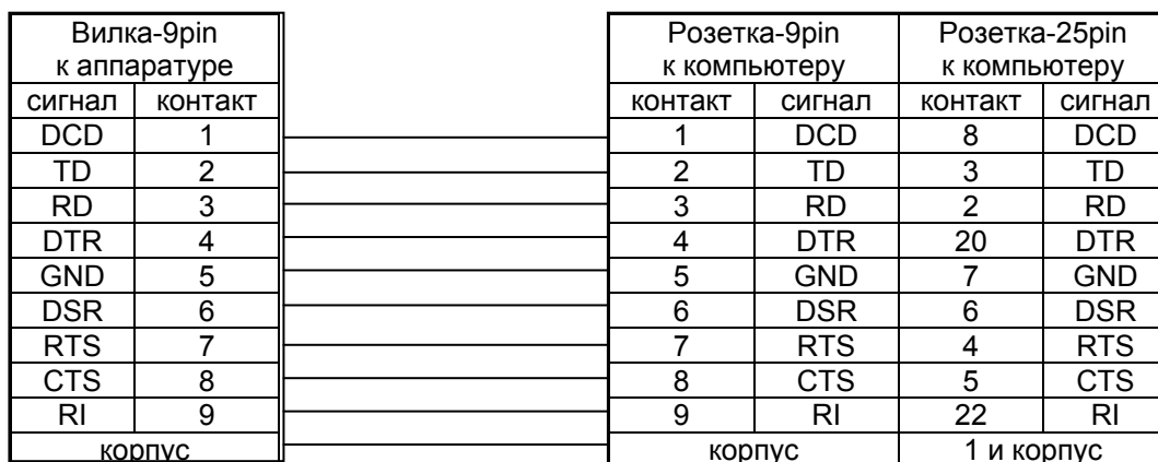
Рисунок 4.1.2 - Схема модемного кабеля типа «ООД – АКД». Сигналы готовности и квитирования не используются
